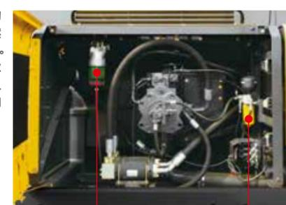
燃料粗滤器（带水分离器） 先导过滤器
